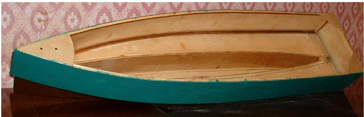
Испытания этой модели показали, что в диапазоне скоростей, соответствующих  $Fr=v/(gL)^{1/2}=0,45\div1,2$ , потребная сила тяги (по сравнению с современными скоростными судами того же водоизмещения) снижается на 30-55% при той же скорости движения (результаты испытаний см. ж. «Судостроение» №2 2006 г.).
